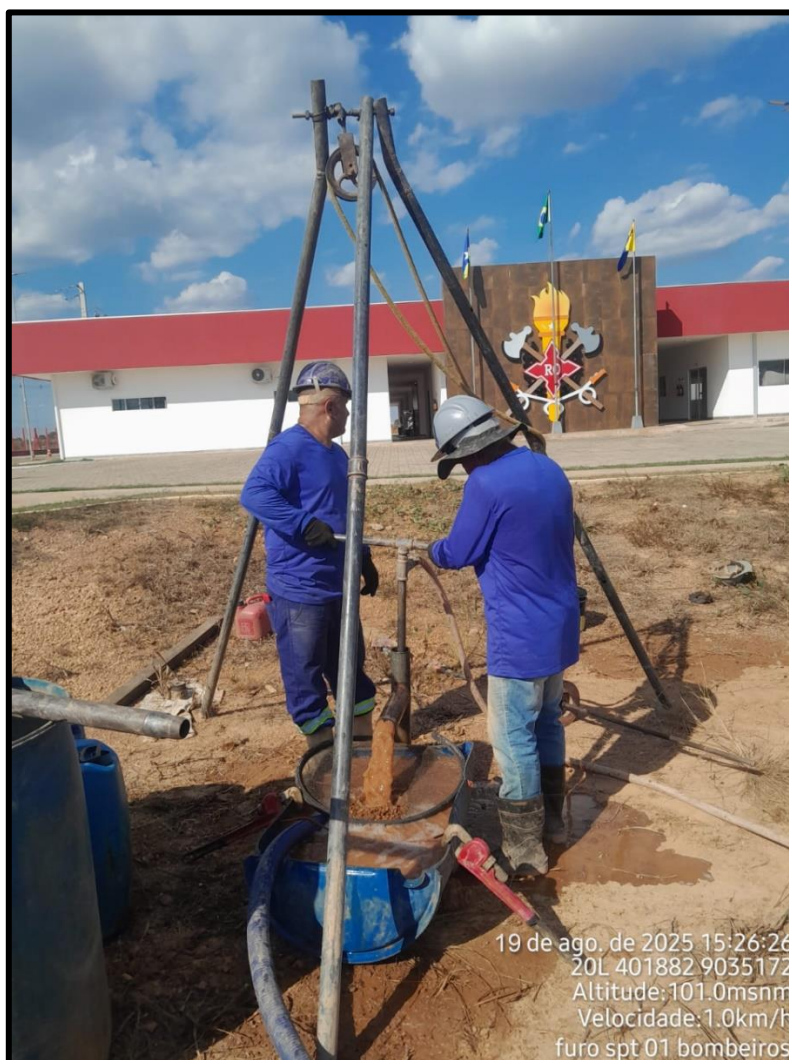
Foto 1 – Execução do Furo SP-1 através da sondagem “Standart Penetration Test – SPT” no terreno do Corpo de Bombeiros Militar de Rondônia.
